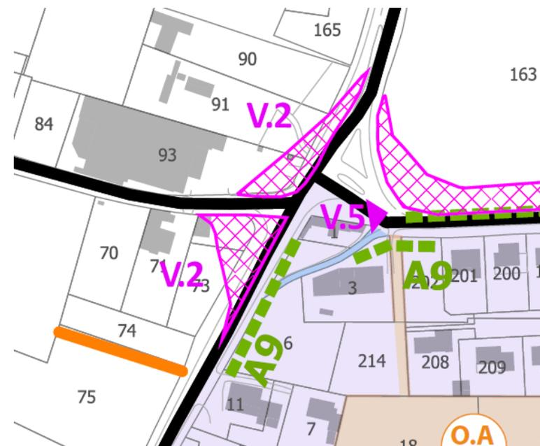
Extrait du zonage : Emplacement Réservé V2 défini pour l'aménagement d'un carrefour sécurisé pour les différents modes de déplacements (RD570n et RD5 / Chemin des Aréniers)
